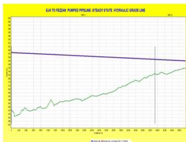
الشكل (3) الإنحدار الهيدروليكي لخط الانابيب الناقل للمياه بالضخ من خزان شرق الحساونة إلى خزان فزان (حالة الجريان المستقر).
